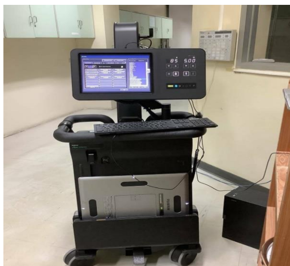
ภาพที่ 5.7 เครื่องเอ็กซเรย์เคลื่อนที่แบบดิจิตอล ชนิดน้ำหนักเบา
