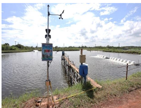
ภาพที่ 4.10 การนำระบบตรวจวัดคุณภาพน้ำอัตโนมัติ (Aqua - IoT) ในบ่อเลี้ยงกุ้ง
